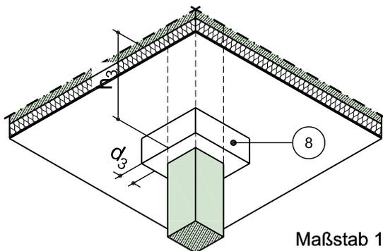
Dimensionierung der Dämmung des Stützenkopfes:
