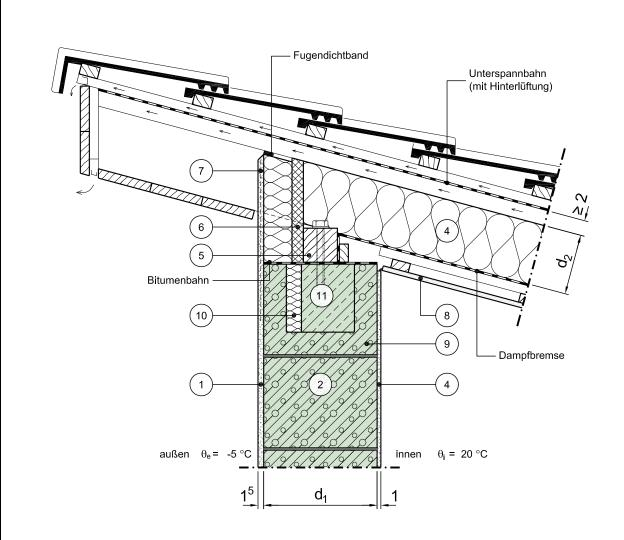
Vertikalschnitt Maßstab 1:10
